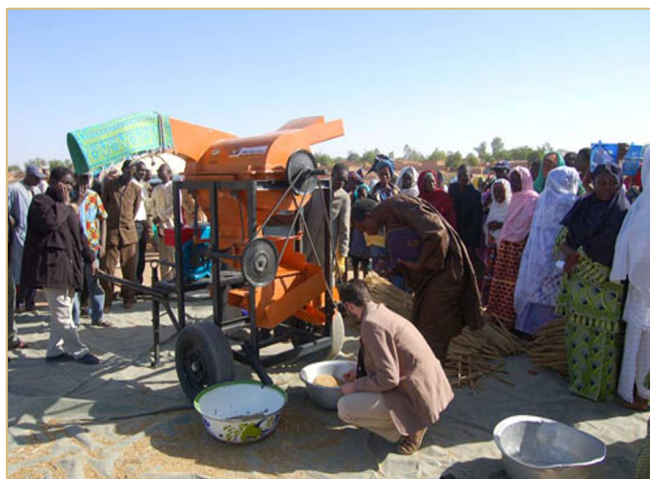
Séance de battage mécanisée à Dosso
