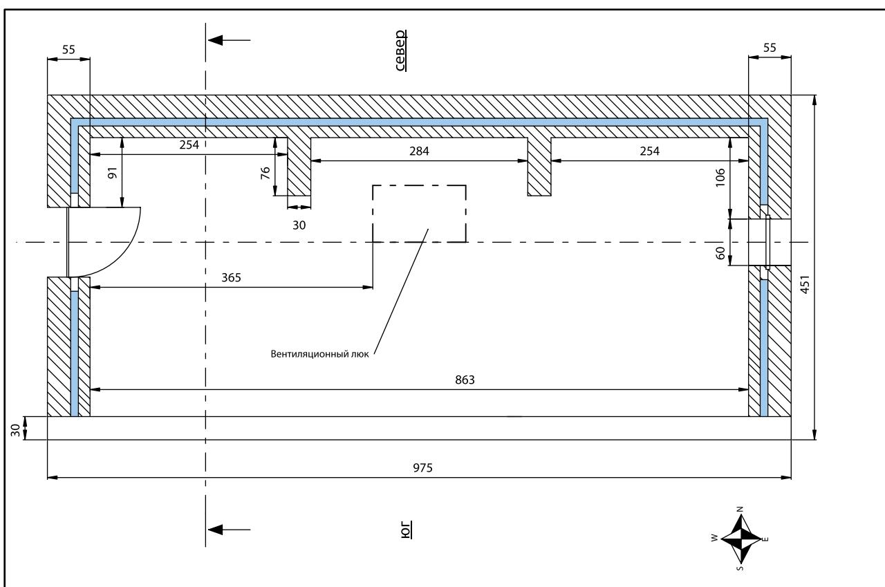
Схема 14 • Конструкция III.B. - Теплица выше 4050 м. Верхний край участка развернут на север
