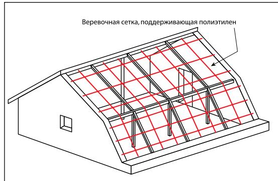
Схема 29 - Веревочная сетка, поддерживающая полиэтилен в случае ветреной погоды.
