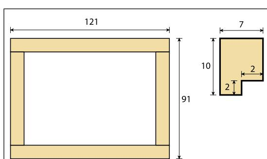
Схема 27 - Подробности изготовления рамы
