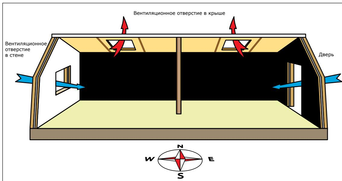
Когда температура внутри теплицы поднимается выше 28°C, все вентиляционные отверстия должны быть открыты для охлаждения теплицы. Когда температура ниже 28°C, все отверстия должны быть закрыты.
