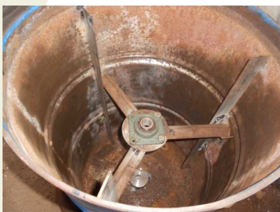
Figure 7 : Support palier intermédiaire
