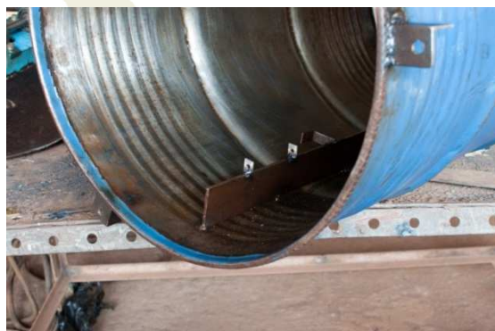
Figure 6 : Contre-pale soudée au fût
