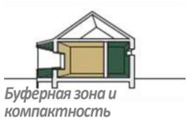
4 см **внешней изоляции** на стенах, утепленные потолки и окна со стеклопакетами имеют важное значение для ограничения потери тепла и обеспечат **тепловой комфорт** внутри дома в зимний период.
