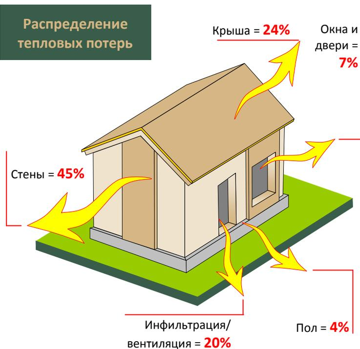
Хотя через стены и крышу теряется основная доля тепла, для теплового комфорта необходимо утепление окон и дверей.
