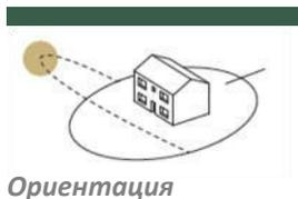
Длина выступа крыши рассчитана таким образом, чтобы максимизировать **доступ тепла в зимний период** и снизить риск **перегрева в летний период**.
