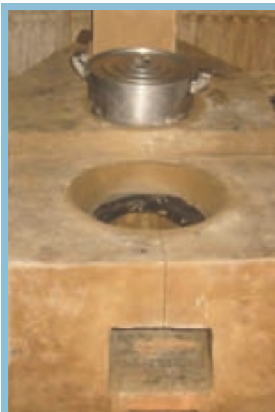
Cuiseur autoconstruit double pot, dénommé cuiseur « Samaki »
