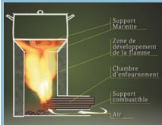
Figure 2 : le principe du rocket stove, GERES (2009)
